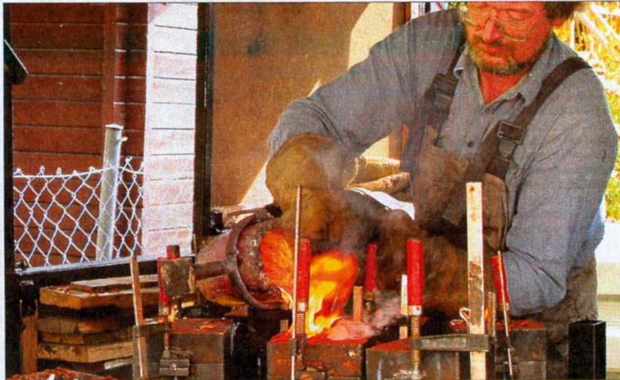
Jetzt wird's gefährlich: Peter Glasbrenner gießt in Fürfeld nacheinander das glühende Metall in die vorbereiteten Glockenformen. Die Kinder sind fasziniert von den züngelnden Flammen. (Foto: Sigrid Friedrich-Wössner)
